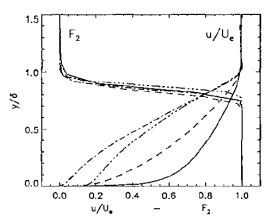
Несмотря на похожее поведение, эти функции должны удовлетворять немного разным критериям. Функция  $F_1$  обязательно должна стать равной 0 к внешней границе пограничного слоя. В противном случае возможно влияние граничных условий для w. Функция  $F_2$  должна обеспечивать значение 1 в максимально широкой части пограничного слоя. Это обуславливает разницу в их формулировке.
